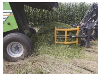
写真1. 通常のネット巻き数ではロールが崩壊
