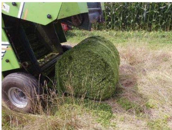
写真 6－3．（左）梱包圧最大設定、ネットの張力を 2.4 倍に設定し、ネットの巻き数は 3 倍とした場合の梱包・排出状況、（右）グリッパの保持状況（慎重に行う必要がありました。）
