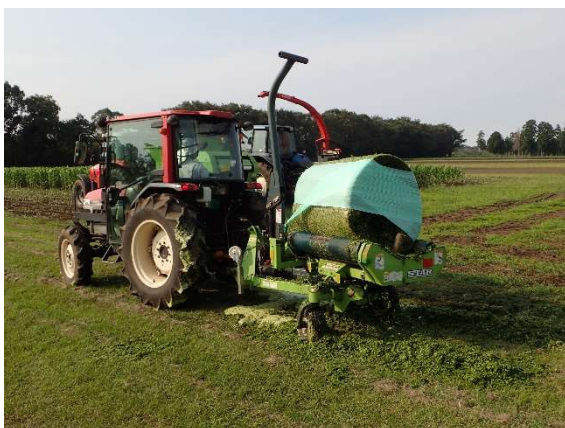
写真6-7. 非常に未熟なトウモロコシロールのラッピングマシンへの積載作業
