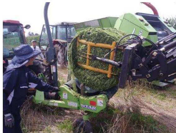
写真 6－3．（左）梱包圧最大設定、ネットの張力を 2.4 倍に設定し、ネットの巻き数は 3 倍とした場合の梱包・排出状況、（右）グリッパの保持状況（慎重に行う必要がありました。）
