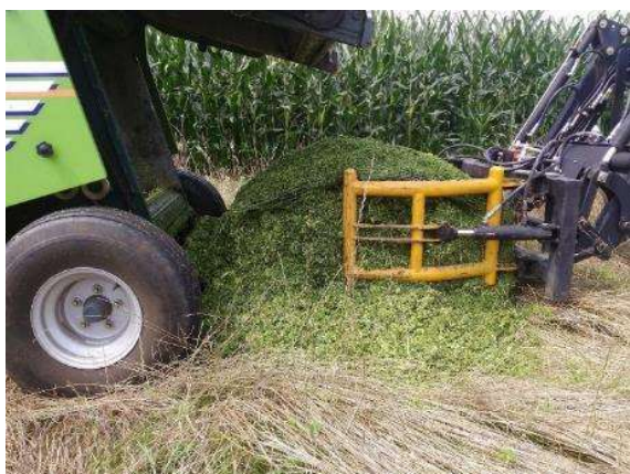
写真6－2．梱包圧最大設定、ネット張力2.4倍に設定し、ネットの巻き数は通常とした場合の梱包・排出状況
