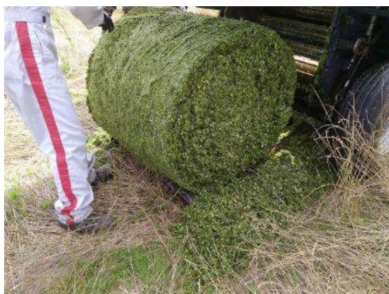
写真6－1．(左)梱包圧通常設定、ネット張力通常、ネット3倍巻きでの梱包・排出状況、(右)排出時は成形できていましたが、ラップ時に変形がみられました。
