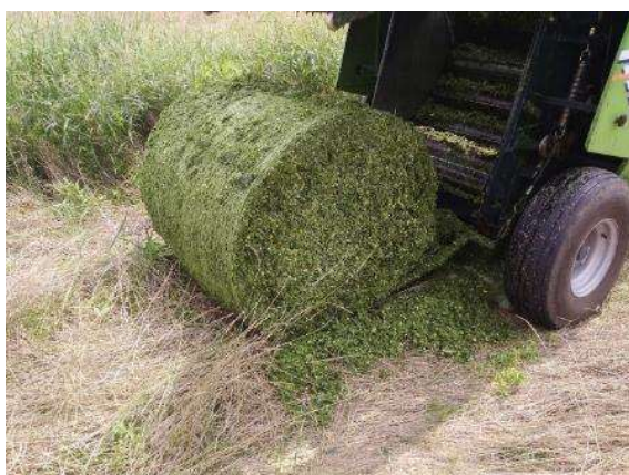
写真 6－4．（左）梱包圧最大設定、ネットの張力を 2.8 倍に設定し、ネットの巻き数は 3 倍とした場合の梱包・排出状況。（右）ラップ後のロールバールの状況（手前から写真 6－1、写真 6－3、写真 6－4 のロールをラップしたものです。）
