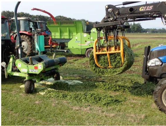
写真6-6. 非常に未熟なトウモロコシロールのグリッパでの持ち上げ
