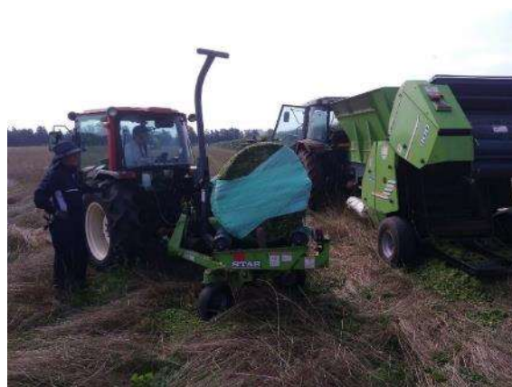
写真6－1．(左)梱包圧通常設定、ネット張力通常、ネット3倍巻きでの梱包・排出状況、(右)排出時は成形できていましたが、ラップ時に変形がみられました。
