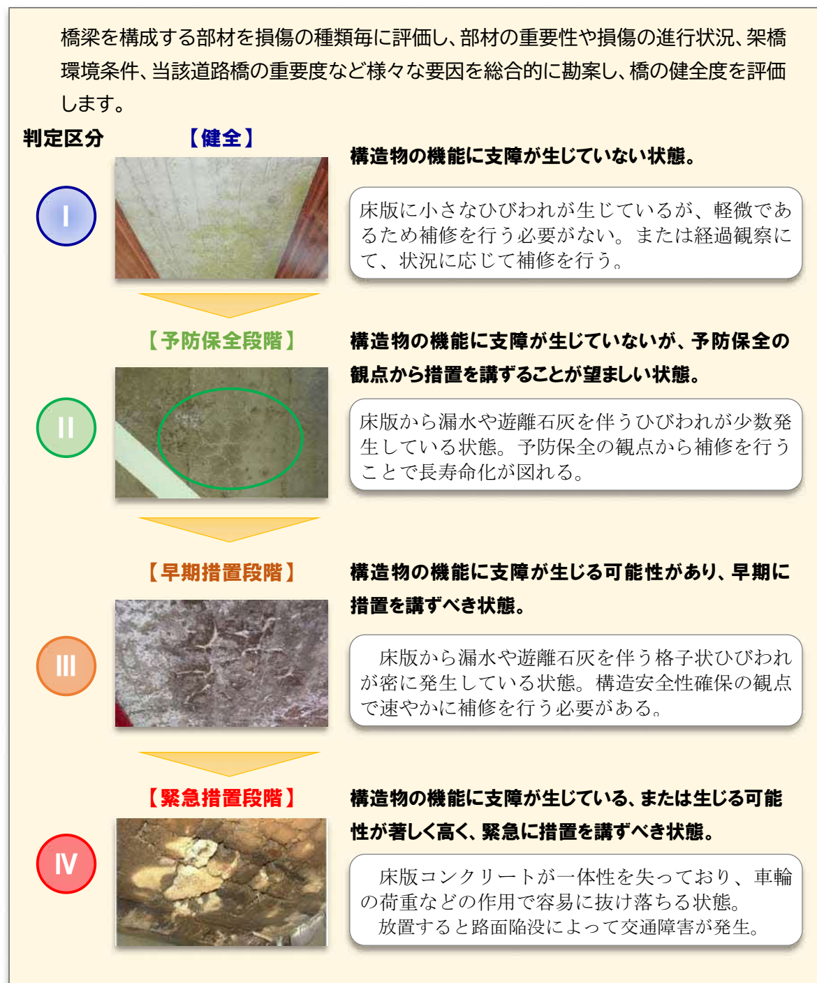
図 15 橋の健全度の事例
