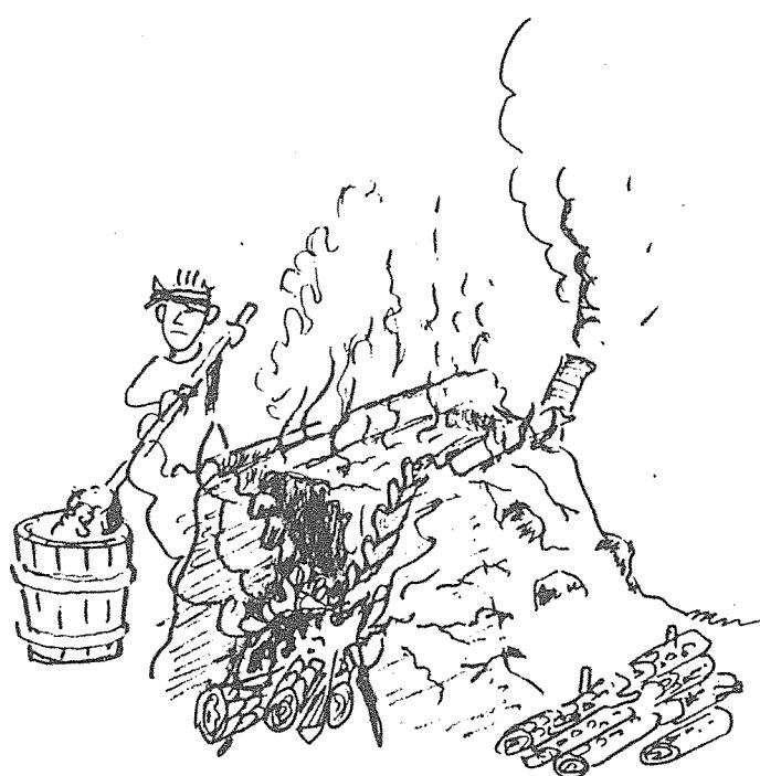
この塩を作るには海岸の砂地の所に先ず小屋を建て、必要な用具の保管と休憩所にあてた。釜はトタンを適当に曲げて長方形のものを造りそれを釜代用にした。釜をのせて炊く所を粘土と石で工夫して造りこれで塩釜の出来あがり。その塩釜の側には塩田を造り広いのは五アール位のもあつた。晴天の日に海水を「たんご」で汲んで「ひしゃく」で塩田にかける。乾いたらかけして二回ないし三回位かけるとその砂の表面が塩で白くなる。そうなるとその砂をかき集めて海水をかけて桶にこすと濃い海水が出来る。その海水を釜で煮つめるのである。最初は火を強くして水分を蒸発させ最後の仕上げになるとろ火にして焼きあげると塩になるのである。
